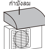
สร้างที่กำบังเพื่อปกป้องยูนิท
